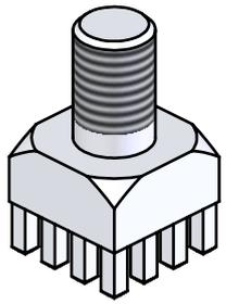
Maximales Drehmoment bei M5.0: 2.2Nm
