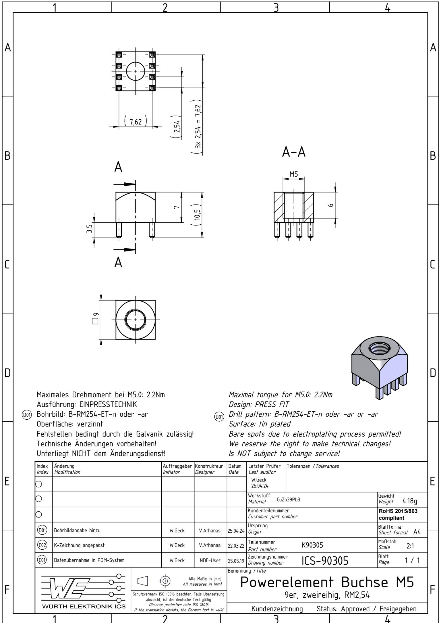
Maximales Drehmoment bei M5.0: 2.2Nm
