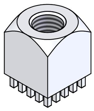
Maximales Drehmoment bei M8.0: 9.0Nm
