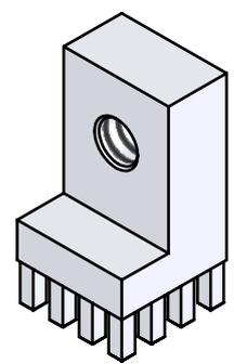
Maximales Drehmoment bei M4.0: 1.2Nm
