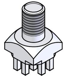
Maximales Drehmoment bei M5.0: 2.2Nm
