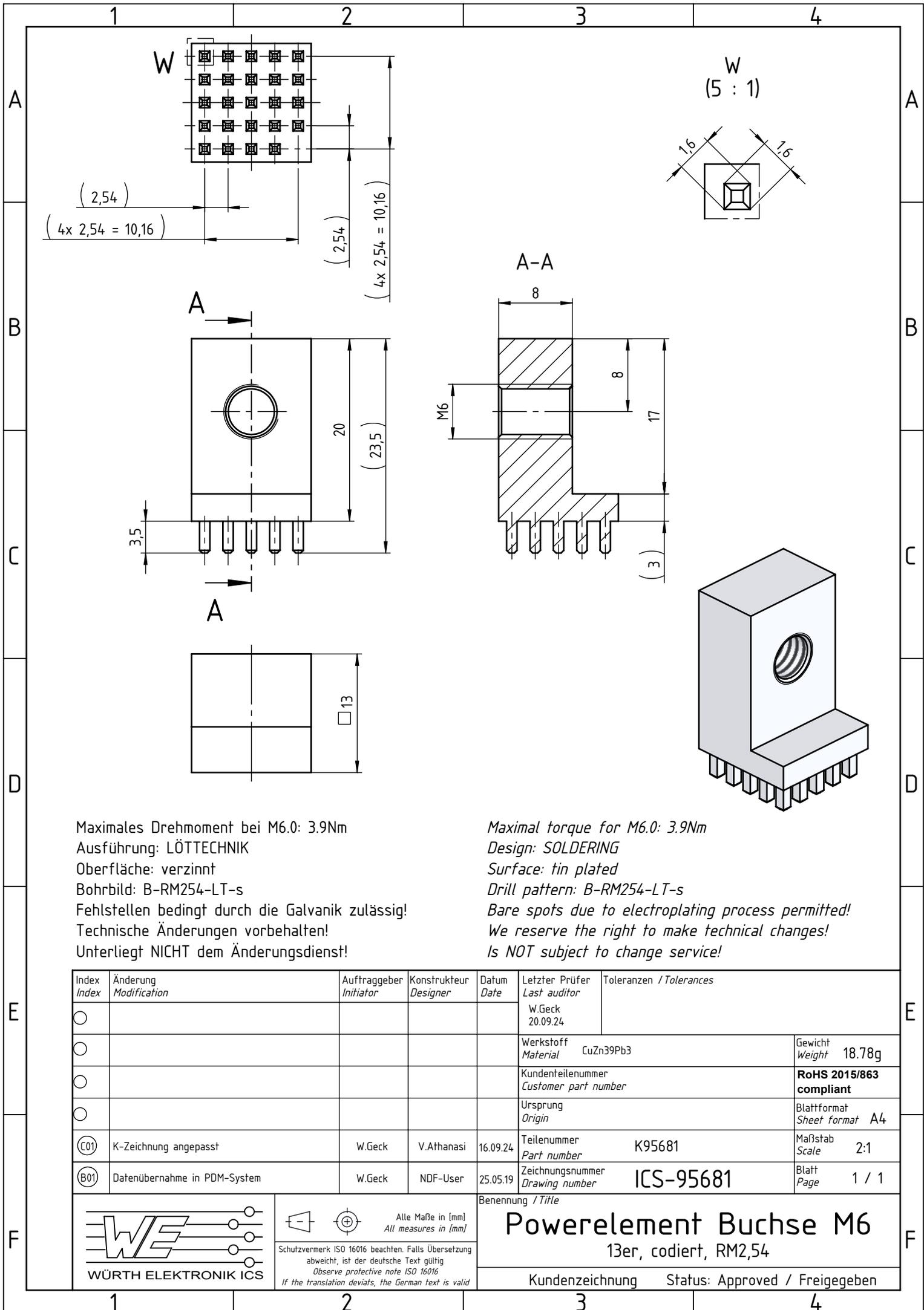
Maximales Drehmoment bei M6.0: 3.9Nm
